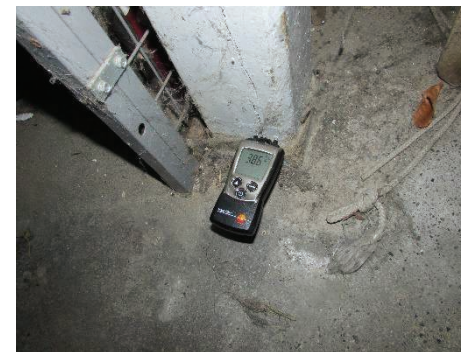
Fugtmåling af træstolpe der holder trapperepos.
